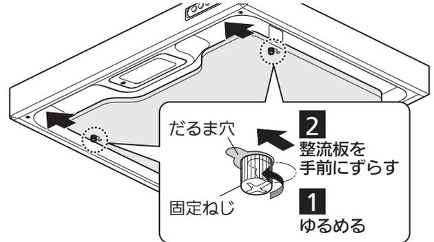
2) 整流板を両手で支え、手前をゆっくりと20cm程度おろした状態で整流板の奥を少し持ち上げ、フードの整流板吊り金具から整流板引掛け金具をはずします。
