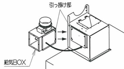
(2) 本体前面から付属の取付ねじ（M4×8）2本にて給気BOXに固定します。
