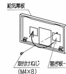
(3) 給気幕板前面より、付属の取付ねじ（M4×8）4本にて給気幕板を給気BOXに固定します。
