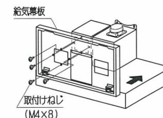
(4) 横幕板を使用しない場合は、給気幕板内側より外面に向けて付属の取付ねじ（φ4.1×16）4本で固定します。
