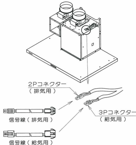
(2) 電動シャッター（給気用）のコネクター接続部（3Pコネクター）に信号線の3Pコネクターを接続します。
