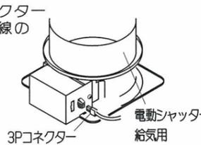
(3) 電動シャッター（排気用）のコネクター接続部（2Pコネクター）に信号線の2Pコネクターを接続します。
