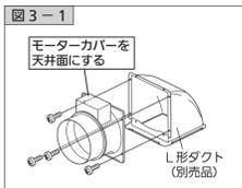
排気電動シャッターのL形ダクトへの取り付け(図3-1)
