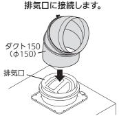
3 もうひとつのフレキシブルダ クトのダクト 150(φ 150) に、 ダクト継ぎ手(取付作業者側 手配)を接続します。
